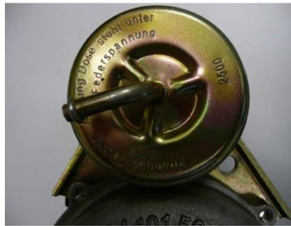
**Der Nachbau hat keine Original-Steuerdose. Seine Funktion ist somit nicht gewährleistet.**
