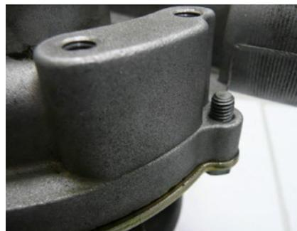
**Beim Nachbau sind die Schrauben zu lang.**
